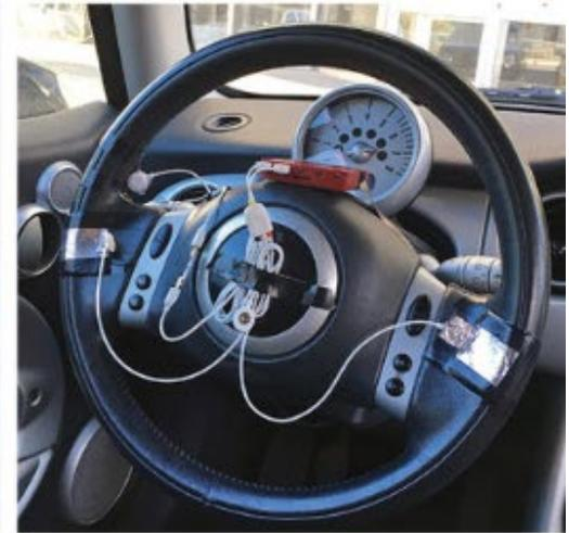
Mit diesen Sensoren am Lenkrad zur EKG- und Impedanzmessung lässt sich das Stresslevel des Fahrers messen.
