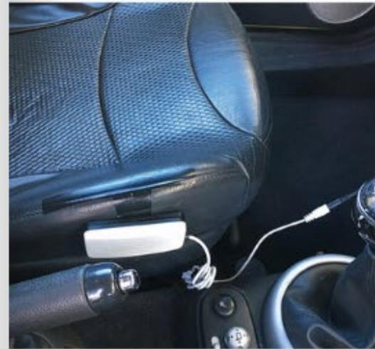
Diese Beschleunigungssensoren am Sitz messen kleinste Vibrationen des Fahrers und geben so Aufschluss über die Atem- und Herzschlagfrequenz.
